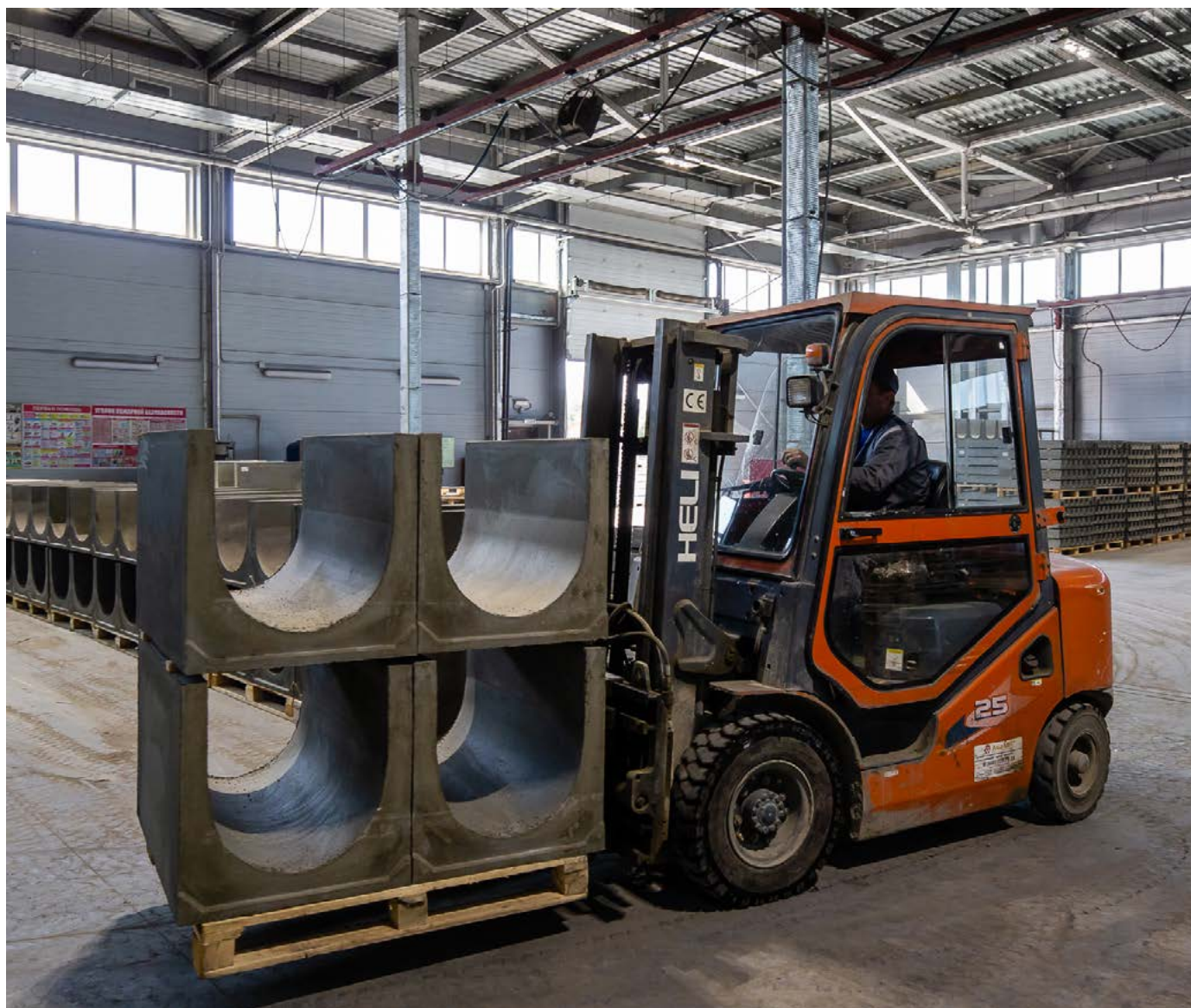
Производство водоотводных систем "Gidrolica" в г. Звенигороде. Бетонные лотки серии BGU
